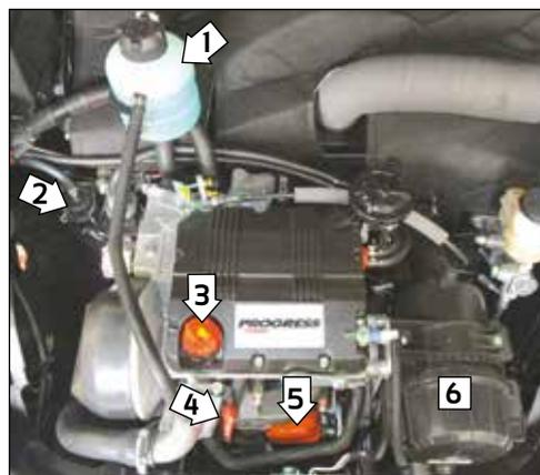
1: Liquide refroidissement. Le niveau doit être situé entre les repères MINI et MAXI présents sur le bocal.
