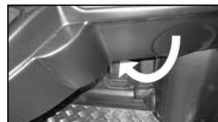
La boîte à fusibles est positionnée sous la planche de bord dans l'habitacle du véhicule côté passager.
