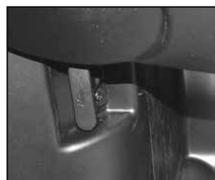
Pour ouvrir la serrure de capot moteur, tirer sur la poignée située dans l'habitacle, sous la planche de bord, côté conducteur, à gauche de la pédale de frein. Le premier cran de la serrure de capot est désengagé.
