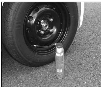
Examiner fréquemment l'état des pneumatiques, une usure anormale peut être due à un problème de géométrie du train avant. L'utilisation de la bombe anti crevaisson n'est destinée qu'à une utilisation provisoire et de courte durée. Il ne faut pas dépasser 35km/h, ne pas effectuer d'accélération franche ou de freinage brusque, ne pas prendre de virage à vive allure.
