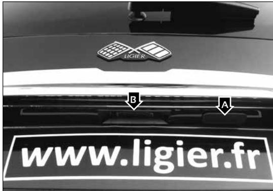
Le hayon possède une commande d'ouverture électrique A située à droite de l'éclairage de plaque d'immatriculation B.
