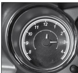
Clé de contact en position arrêt **S**, l'horloge affiche par défaut 12h. En position accessoire **A**, l'horloge affiche l'heure réglée.
