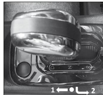
Pour effectuer une manœuvre de recul, appuyer sur le pommeau pour enfoncer le levier vers le bas puis le tirer vers l'arrière, jusqu'à son enclenchement en position **R**. Si le véhicule en est équipé, le bip de fonctionnement du radar de recul retenti. Le témoin lumineux **R** s'allume sur l'écran du compteur.
