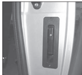
Photo 2 Ouverture du hayon arrière par tirette (montant de porte gauche)
