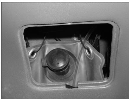
Contrôler fréquemment le niveau du liquide lave glace et le remplir si nécessaire. Si vous n'avez pas de liquide spécifique disponible, il est possible d'utiliser un peu d'eau pure. Toutefois en cas de basse température il est nécessaire d'utiliser du liquide de lave-glace avec des solutions antigel.
