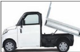
Le vérin hydraulique se manipule à l'aide de la télécommande jaune fournie. connecter la télécommande sur la prise située sous le siège passager. Le vérin hydraulique peut être utilisé sans contact.
