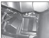
La boîte à fusibles est positionnée sous la planche de bord dans l'habitacle du véhicule côté passager.
