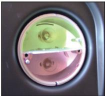
Pour accéder à une ampoule de clignotant, feu antibrouillard ou feu de recul, utiliser la même procédure décrite ci-dessus et déposer également la lentille de couleur par ampoule, maintenue par une vis.
