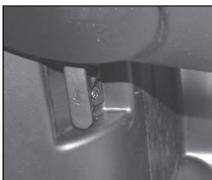
Pour ouvrir la serrure de capot moteur, tirer sur la poignée située dans l'habitacle, sous la planche de bord, côté conducteur, à gauche de la pédale de frein. Le premier cran de la serrure de capot est désengagé.
