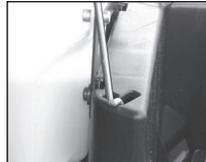
La béquille de capot est clipsée sur la face intérieure du capot côté conducteur. Pour soutenir le capot, placer la béquille sur le support prévu à cet effet.
