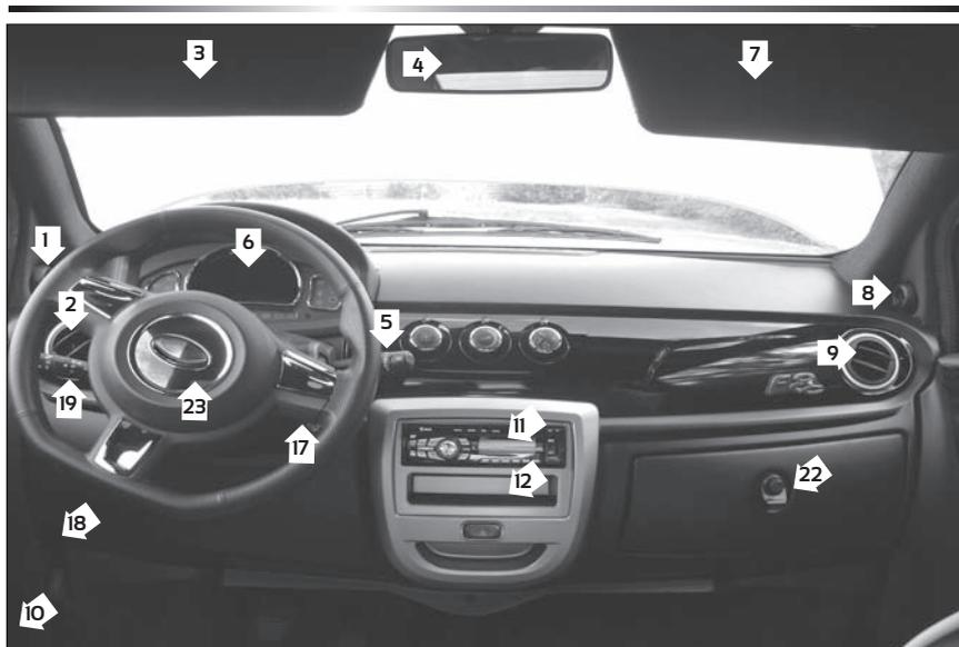
1. Commande manuelle rétroviseur extérieur gauche
