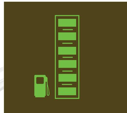
L'indication du niveau est visualisée par une série de 6 barres lumineuses.
