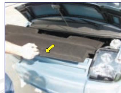
Déposer l'insonorisation en la retirant du compartiment moteur vers l'avant.
