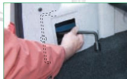
La manivelle est accrochée sur le flanc gauche à l'intérieur de l'habillage du coffre arrière.
