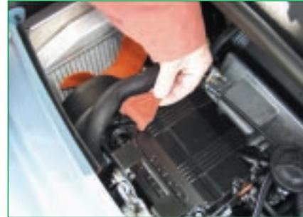
Pour ajouter de l'huile, tirer le bouchon de remplissage en tête moteur. Vérifier le niveau après avoir remis le bouchon.
