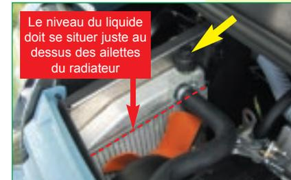
Le niveau du liquide doit se situer juste au dessus des ailettes du radiateur
