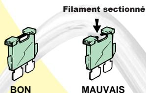
**Toujours remplacer les fusibles par des fusibles de même ampérage. Ne jamais rien mettre à la place du fusible, même provisoirement, ceci pourrait provoquer un court-circuit allant jusqu'à mettre le feu au véhicule.**
