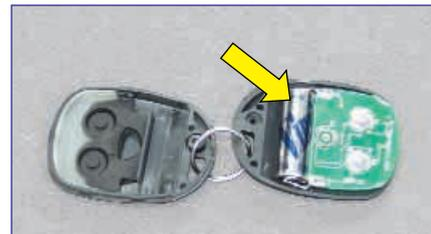
Pour changer la pile de la télécommande, ouvrir le boîtier.
