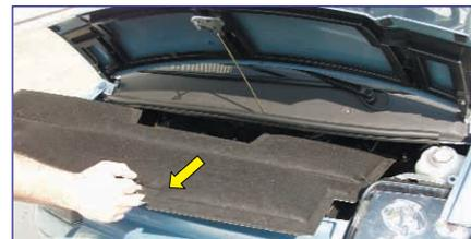
Déposer l'insonorisation en la retirant du compartiment moteur vers l'avant.
