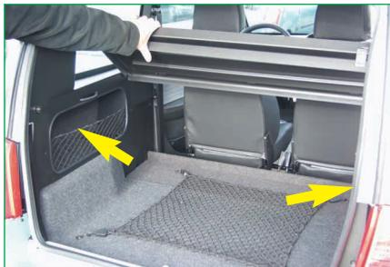
Sur la MC2 la tablette arrière est repliable en deux éléments et des espaces supplémentaires de rangement sont prévus dans les ailes arrière et derrière les sièges.
