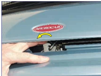
Soulever le capot pour permettre de déverrouiller le crochet de sécurité (retenue de capot),
