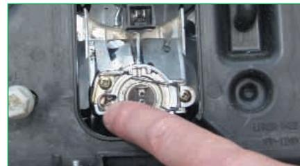
Pincer les extrémités du ressort de maintien de l'ampoule.
