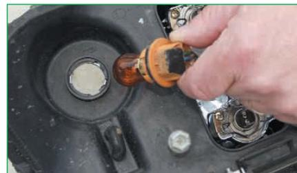
Retirer le porte-ampoule par l'arrière du bloc feu en le tournant d' 1/4 de tour.
