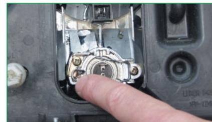
Pincer les extrémités du ressort de maintien de l'ampoule.
