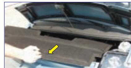
Déposer l'insonorisation en la retirant du compartiment moteur vers l'avant.
