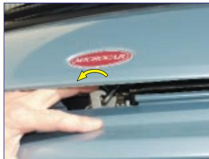
Soulever le capot pour permettre de déverrouiller le crochet de sécurité (retenue de capot),
