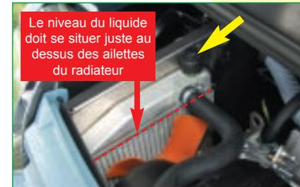
Le niveau du liquide doit se situer juste au dessus des ailettes du radiateur
