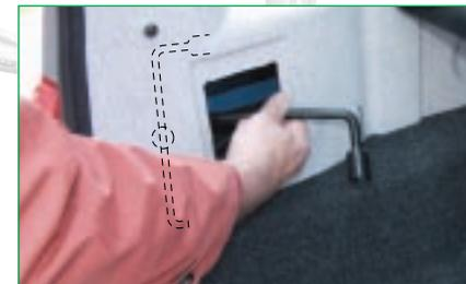
La manivelle est accrochée sur le flanc gauche à l'intérieur de l'habillage du coffre arrière.
