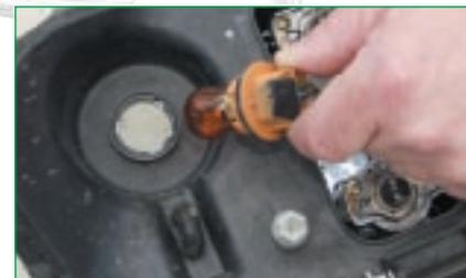
Retirer le porte-ampoule par l'arrière du bloc feu en le tournant d' 1/4 de tour.
