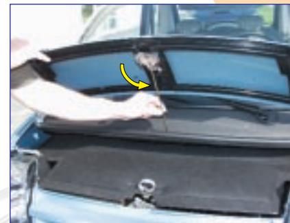
Lever le capot et le maintenir en position à l'aide de la tringle.
