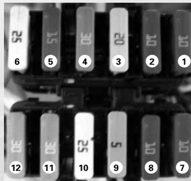
**ATTENTION** : Toujours remplacer les fusibles par des fusibles identiques et de même ampérage. Ne jamais rien mettre à la place des fusibles, ceci pourrait provoquer un court circuit allant jusqu'à mettre le feu au véhicule.
