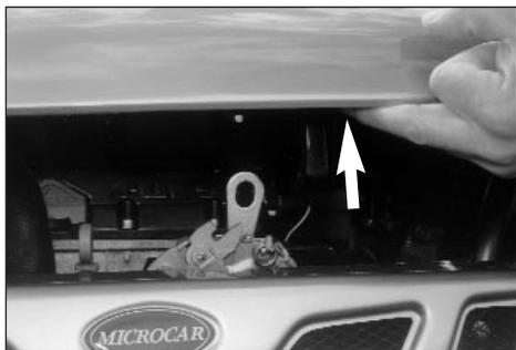
Soulever le capot pour permettre d'appuyer sur la palette de sécurité (retenue de capot),
