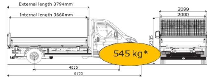
Benne 3700 mm sur Châssis cabine L3 / L
