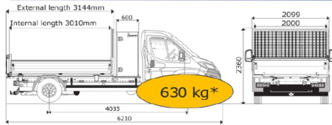
Benne 3050 mm avec coffre sur Châssis cabine L3 / L
