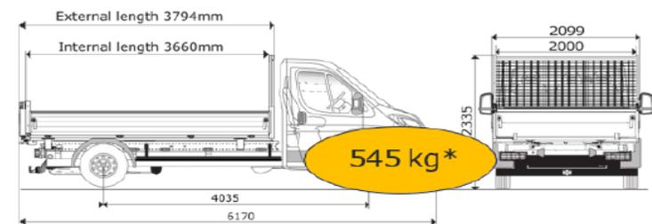
Benne 3700 mm sur Châssis cabine L3 / L
