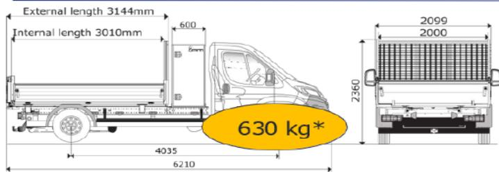
Benne 3050 mm avec coffre sur Châssis cabine L3 / L
