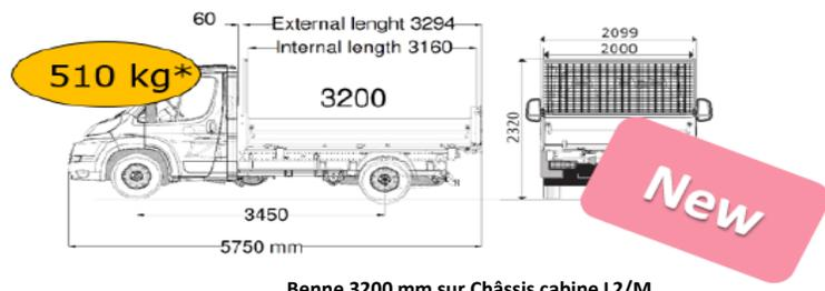
Benne 3200 mm sur Châssis cabine L2/M
