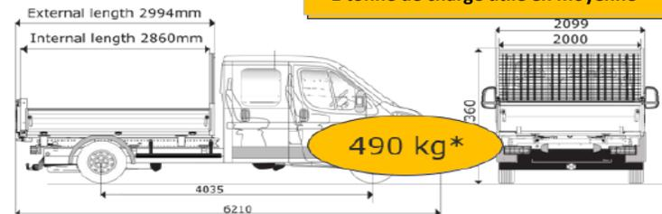
Benne 2900 mm sur Châssis double cabine 7 places
