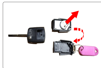
Fig. 101 - Compartiment de la pile.
