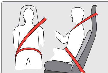
Fig. 8 - Sangle de la ceinture correctement ajustée, vue de face et de côté.
