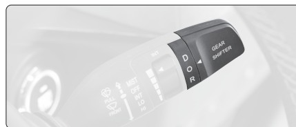
Fig. 31 - Sélecteur de rapport - Situé à l'extrémité du levier, côté droit derrière le volant.
