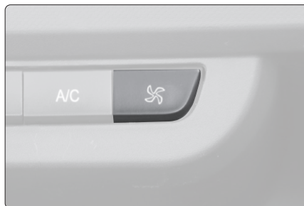
Fig. 47 - Bouton d'activation de la ventilation.
