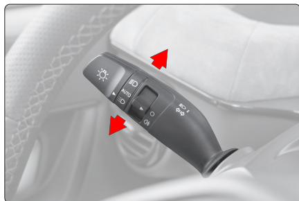
Fig. 28 - Commande des feux - Située derrière le volant, côté gauche.
