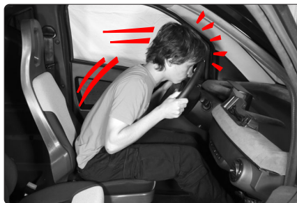
Fig. 5 - Le conducteur ne portant pas la ceinture de sécurité se trouvera projeté vers l'avant.
