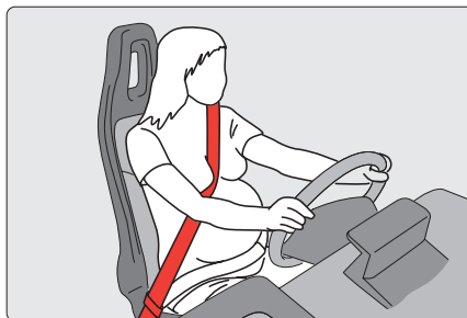
Fig. 9 - Pose de la sangle de la ceinture dans le cas des femmes enceintes.
